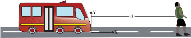
Para hallar una expresión para la aceleración del bus necesitamos la velocidad inicial y final, y el tiempo que dura la aceleración. La velocidad final en este caso es de magnitud  $v_p$  en el sentido positivo de  $X$  según nuestro sistema, y la velocidad inicial es de magnitud  $v_t$  en el sentido positivo de  $X$ . Si escribimos la ecuación para la aceleración del bus, tenemos
